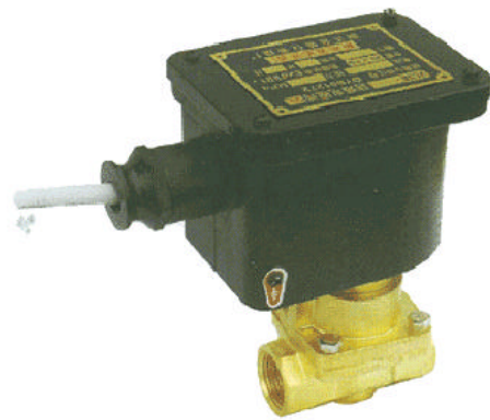
主阀配置 PS 阀 型号为：ZCSB-()P 工作压力：0.03~1.6Mpa 活塞式、先导式结构 介质温度 135
