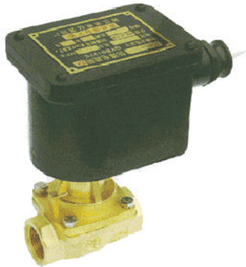
主阀配置 RSPS 阀 型号为：ZCSB-()R 工作压力：0~1.6Mpa 活塞式、直动式结构 介质温度 135
